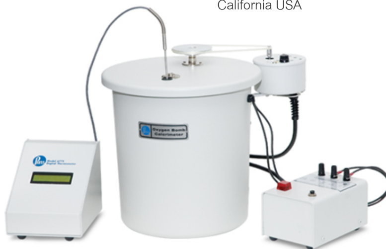
ภาพที่ 1 เครื่องบอมบ์แคลอรีมิเตอร์สำหรับหาค่าพลังงานของตัวอย่างน้ำมันมะพร้าว
